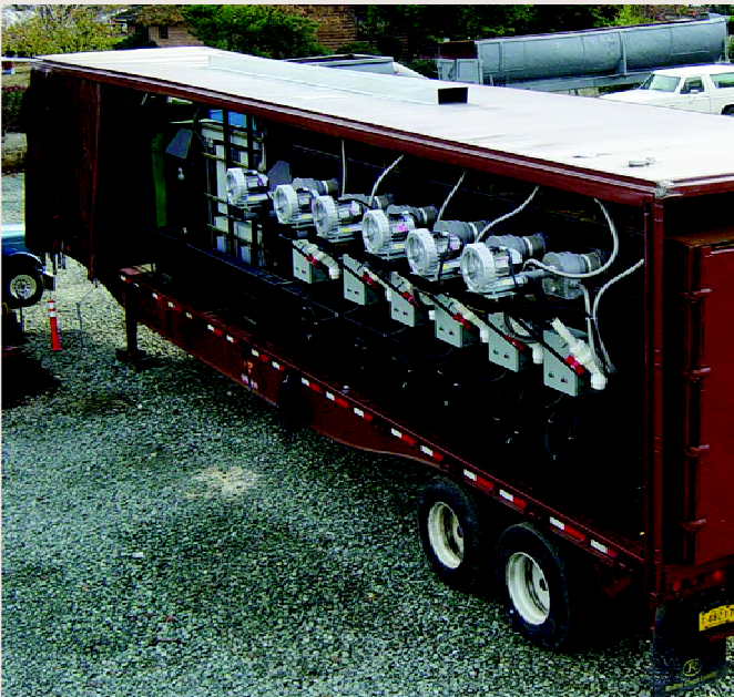
Brady环境公司的专利热风土壤蒸馏系统，模块化设计。在空气系统使用莱丹加热器蒸发污染土壤。
