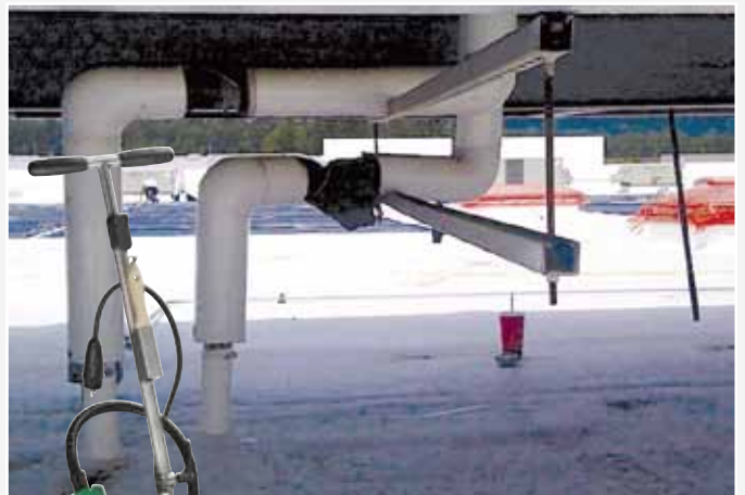
新产品VARIMAT V2，设计有可调节的导向手柄，因此可以方便地调节高度以顺利通过通风口，管道和其它障碍物。
