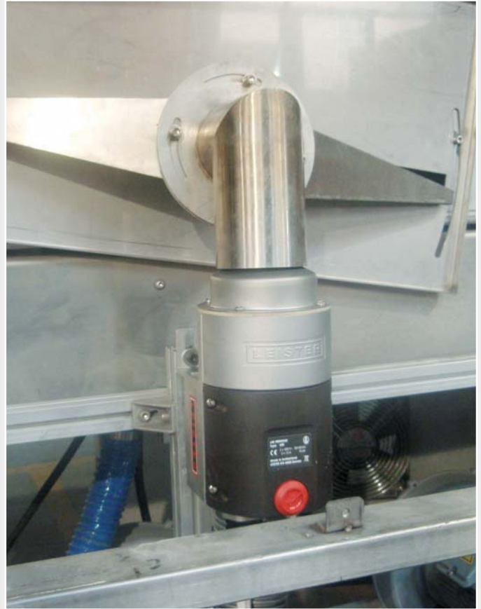
安装在样机上带宽槽风嘴的新型加热器 LHS PREMIUM 60S
