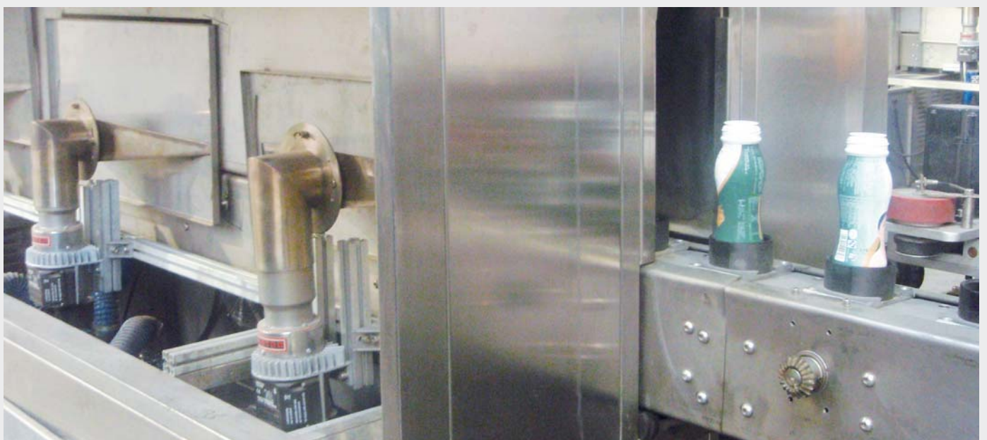
两边安装3台LE 5000空气加热器的热缩通道。
