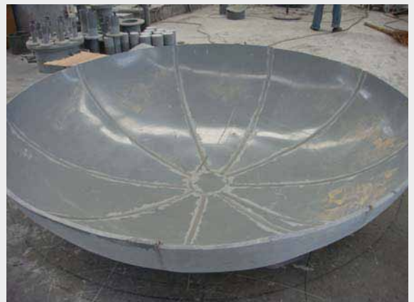
使用挤出焊枪WELDPLAST S2 PVC焊制而成的容器盖板
