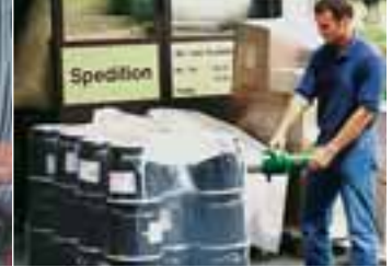
Flammenloses Einschrumpfen von Paletten und Sperrgütern mit FORTE S3. Damit sind Arbeiten in geschlossenen Räumen möglich.
