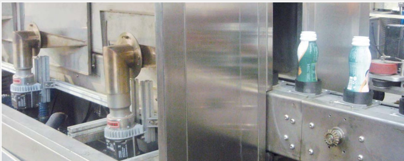
Schrumpftunnel mit beidseitig drei Lufterhitzern LE 5000.
