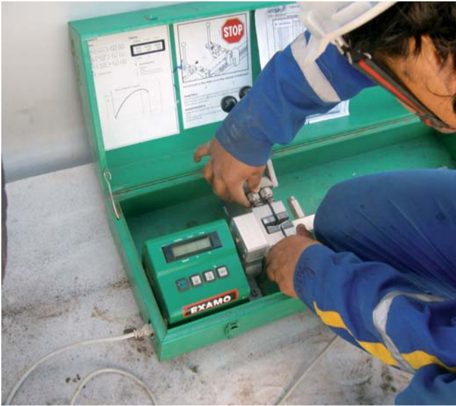
Das Zugprüfgerät EXAMO zur Kontrolle der relevanten Schweißparameter.
