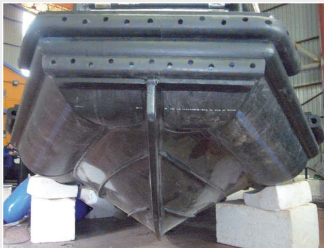
Bootsunterseite mit stumpfgeschweissten und extrudierten Teilen.
