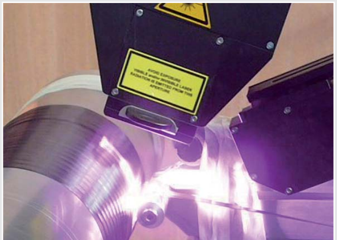
Schweißen CFK-Bänder (Bild: MF-Tech, Frankreich - www.mftech.fr )
