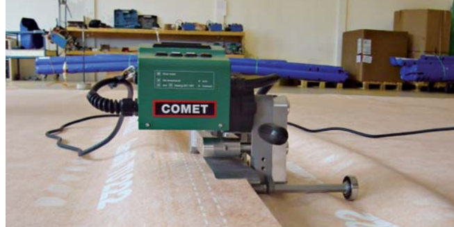
Automatisches Schweißen dank integrierten Führungsblechen.
