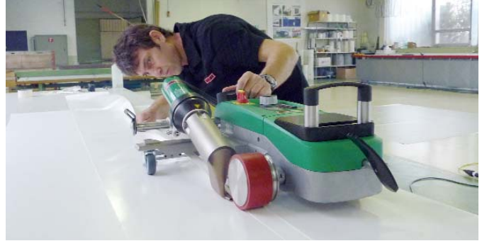
Einfaches Saum- und Kederschweißen mit dem Saum-/Kederkit.
