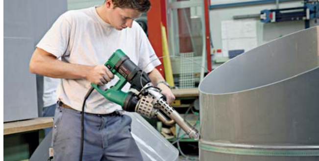
FUSION 3C beim Schweißen einer V-Naht.
