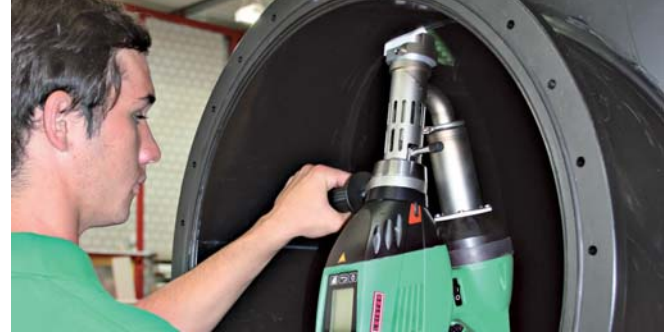
Einfaches Schweißen selbst von Innenradien.
