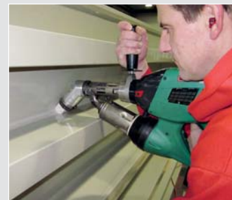
Erleichtert das Schweißen in schwierigen Positionen: Der 45°-Winkelkopf des WELDPLAST S2. (Zubehör)
