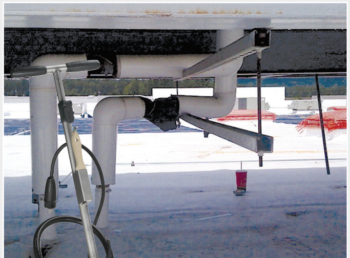
Der VARIMAT V2 kann dank seines verstellbaren Führungsstabs in der Höhe angepasst und so unter Hindernissen hindurch geführt werden.
