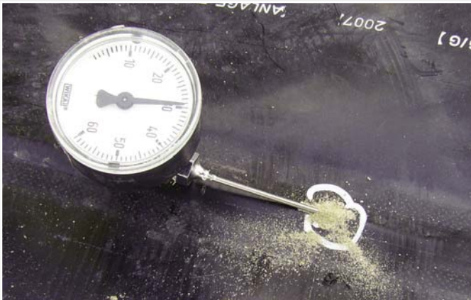
Mit der Düsenadel wird die Dichtigkeit der (einwandfrei) verschweissten Naht geprüft.
