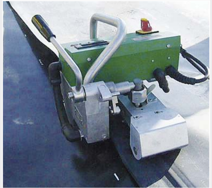
Der ASTRO verschweisst die HD-PE-Dichtungsbahnen mit einer Geschwindigkeit von bis zu 5 m/Min.
