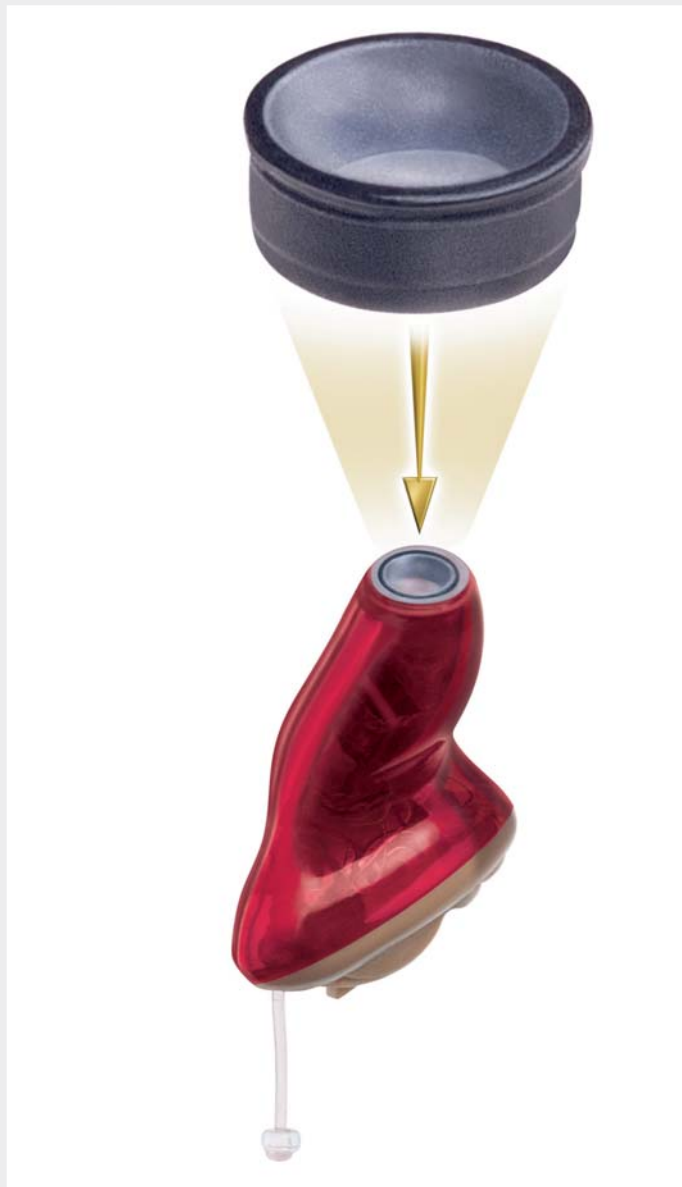
Le système de protection «SmartGuard» avec la membrane mince de seulement 15 µm est assemblé avec l'anneau de support grâce au soudage au laser.
