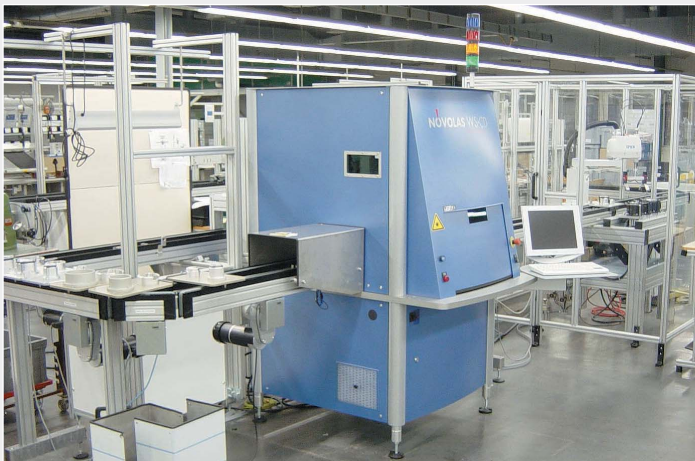
Le système laser est intégré dans une chaîne de production avec système de transfert.
