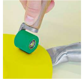
Un soudage simple est garanti avec le rouleau de pression manuel ergonomique.
