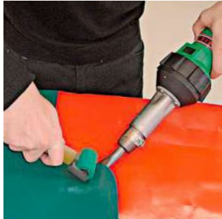
TRIAC PID : Température de soudage contrôlée pour une qualité parfaite.
