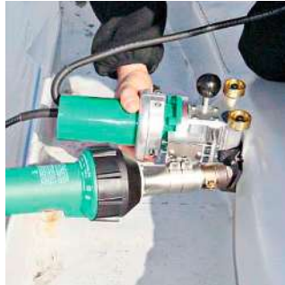
Il est même possible de souder horizontalement avec le TRIAC DRIVE PID.
