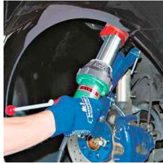
Accélération du processus de séchage de vernis, peinture et mastics appliqués, ainsi que bordage avec l'ELECTRON.
