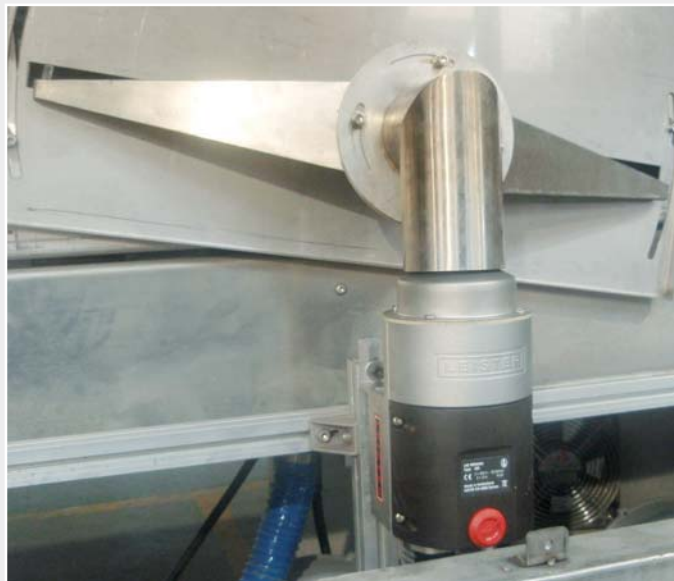
Un réchauffeur d'air LHS PREMIUM 60S avec buse à fente large dans l'installation d'essai.
