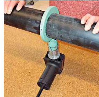
Saldatura a specchio di tubi.
