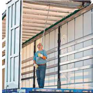
Strisce di rinforzo per le coperture fisse e scorrevoli dei teloni per camion. Figura: „Krone“
