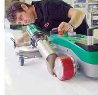
Facile saldatura di orlatura e rinforzo con l'apposito kit.
