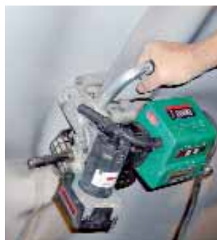
TWINNY T con maniglia trasversale pratica per la saldatura aerea all'interno di tunnel.
