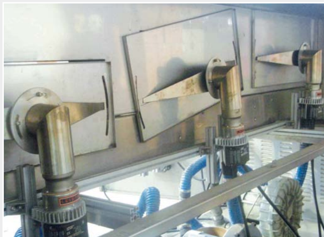
Orientamento individuale degli ugelli a fessura larga Leister sul prodotto termoretraibile
