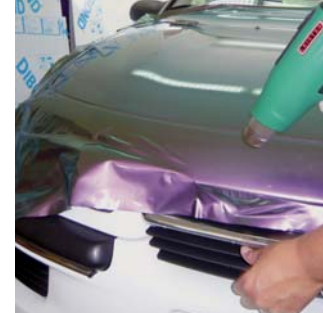
車両ラッピングとフィルム接着
