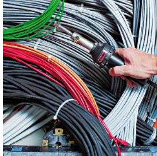
ホットストリームSとコの字型リフレクターによるはんだシュリンク接続
