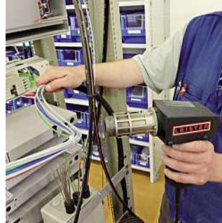
ファイバー・チューブケーブルをさらに処理するために、加熱しています。
