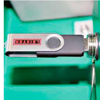
O dispositivo USB providencia uma avaliação controlável dos resultados de soldadura no EXAMO.
