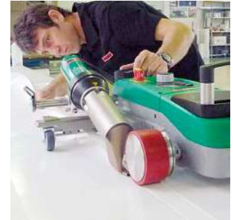
Soldagem de bainha facilitado com o kit de bainha.
