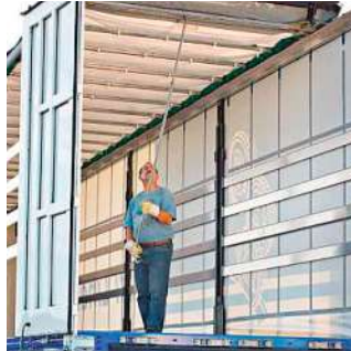
Tira de reforço para coberturas fixas e de movimentação de lonas para camiões.
