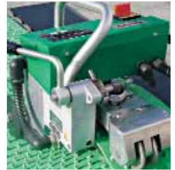
Versão especial para placas de proteção em Polietileno de alta densidade, projetado para proteger estrutura de concreto em ambientes corrosivos e erosivos.
