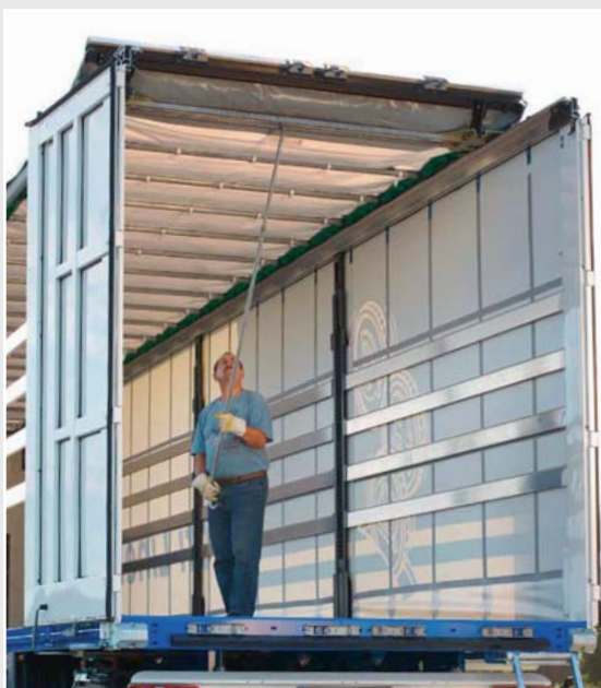
Pasy wzmacniające nad belkami (zdjęcia: Krone)
