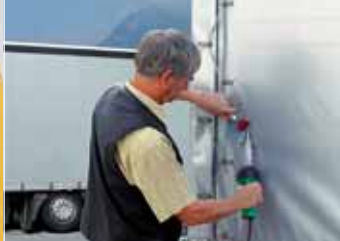
Reparatie la prelata unui camion folosind TRIAC PID cu duza lata si rola de presare
