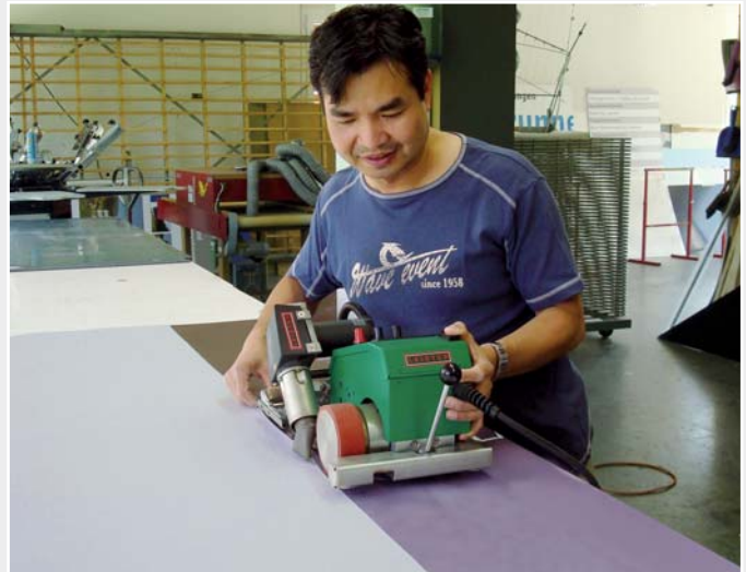
Aquí podemos ver el procesamiento de un banner utilizando el equipo UNIPLAN E.
