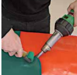
TRIAC PID: Temperatura de soldadura controlada para una calidad perfecta.
