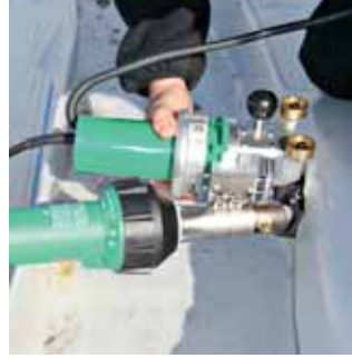
Con el TRIAC DRIVE PID puede soldarse hasta horizontalmente.
