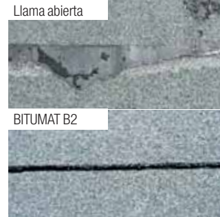
Los resultados son obviamente mejores frente a la soldadura con llama abierta.
