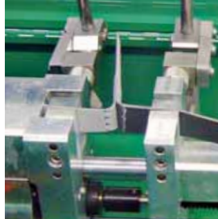
Prueba de un cordón de soldadura con el EXAMO USB.
