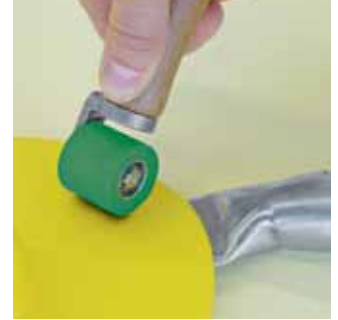
El ergonómico rodillo de presión manual permite soldar con facilidad.
