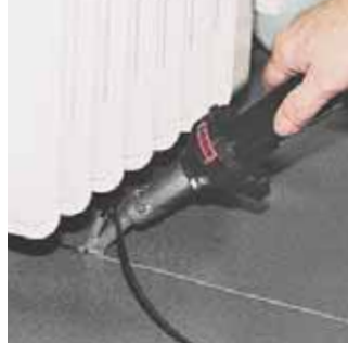
El HOT JET S es especialmente útil para realizar soldaduras en lugares de difícil acceso.
