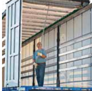
Tiras de refuerzo para capotas fijas y corredizas de lona de camiones.
