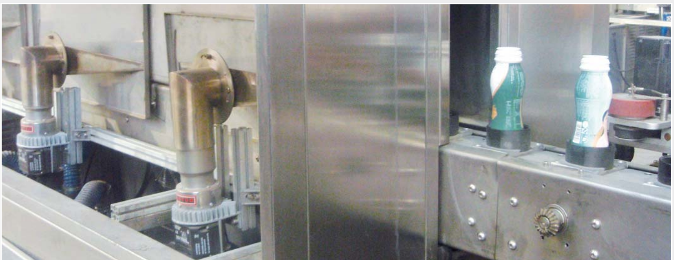
Túnel de retracción con tres calentadores de aire LE 5000 en ambos lados.
