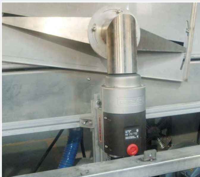
Un calentador de aire LHS PREMIUM 60S con boquilla de ranura ancha en la instalación de prueba.
