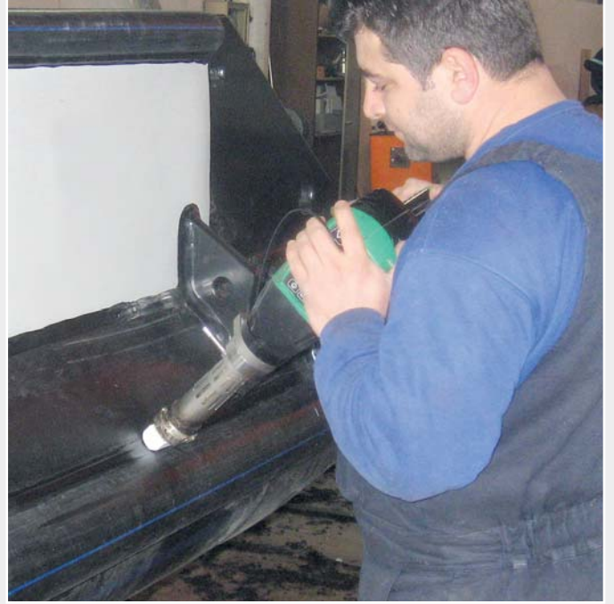
Kullanışlı WELDPLAST S2 ile ekstrüzyon kaynağı
