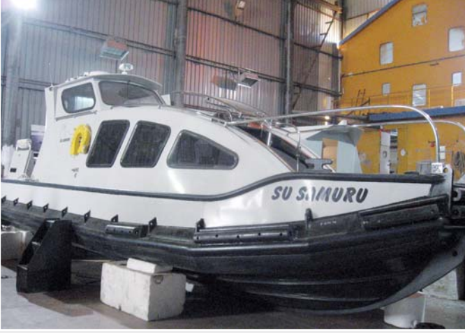
PE'den üretilmiş plastik yolcu taşıma botu
