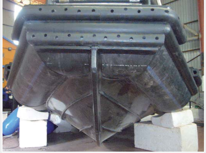
Tekne alt gövdesindeki ekstrüzyon kaynakları
